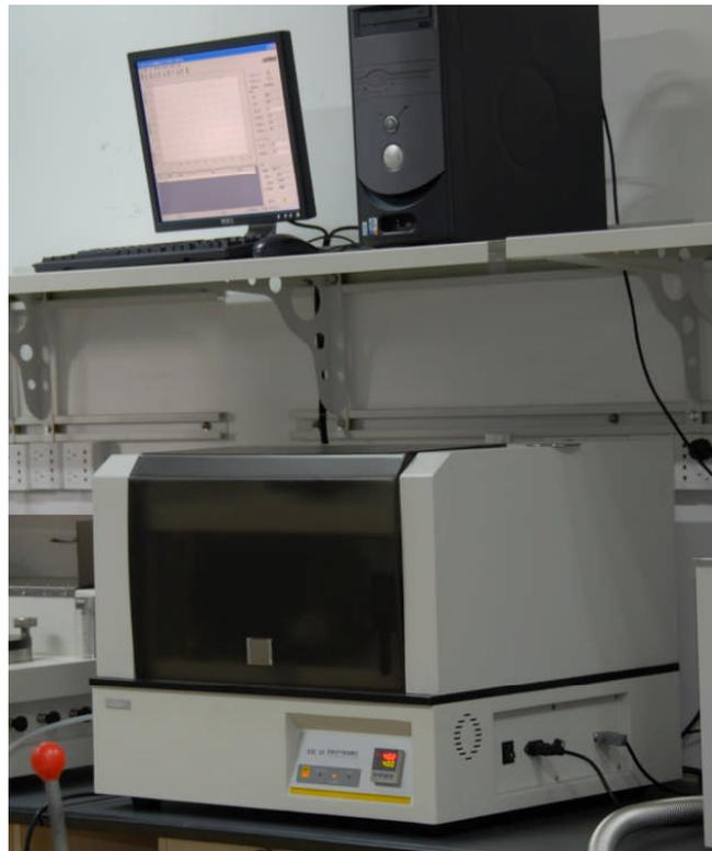
图 2. VAC-V1 压差法气体渗透仪
