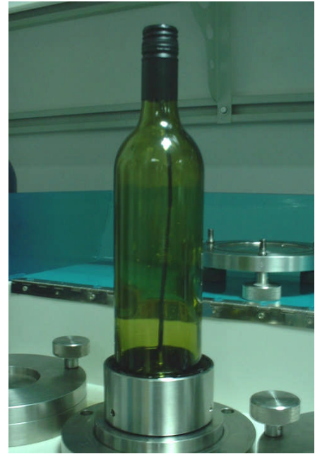
图 2. 制作完成的容器整体透氧性
