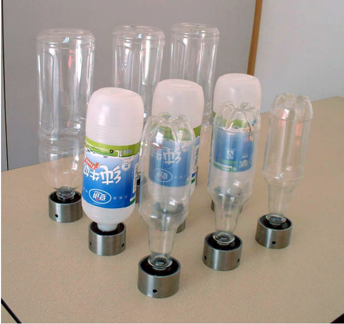
图 1. 制作完成的瓶体透氧性检测试样
