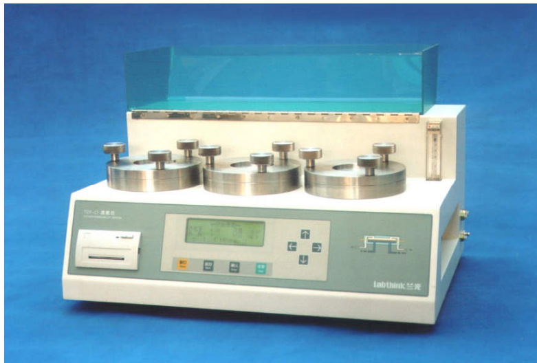
图 3. 薄膜试样装夹完毕的 TOY-C1 透氧仪
